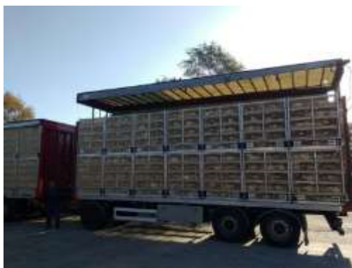
Figure 2.3 Les camions devraient être équipés de toits pouvant être soulevés pour éviter le stress thermique
